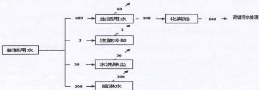
图 3-5 项目水平衡图（单位：m 3 /a）
