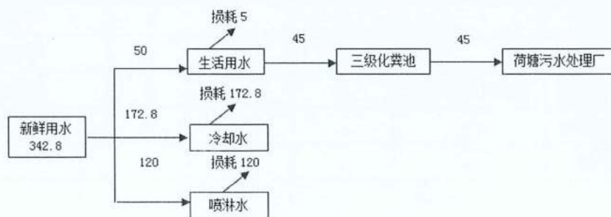
图 3.5 项目水平衡图 (单位: t/a)
