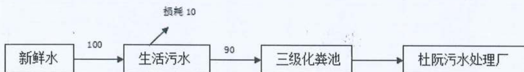
图 3.5 项目水平衡图(单位: t/a)
