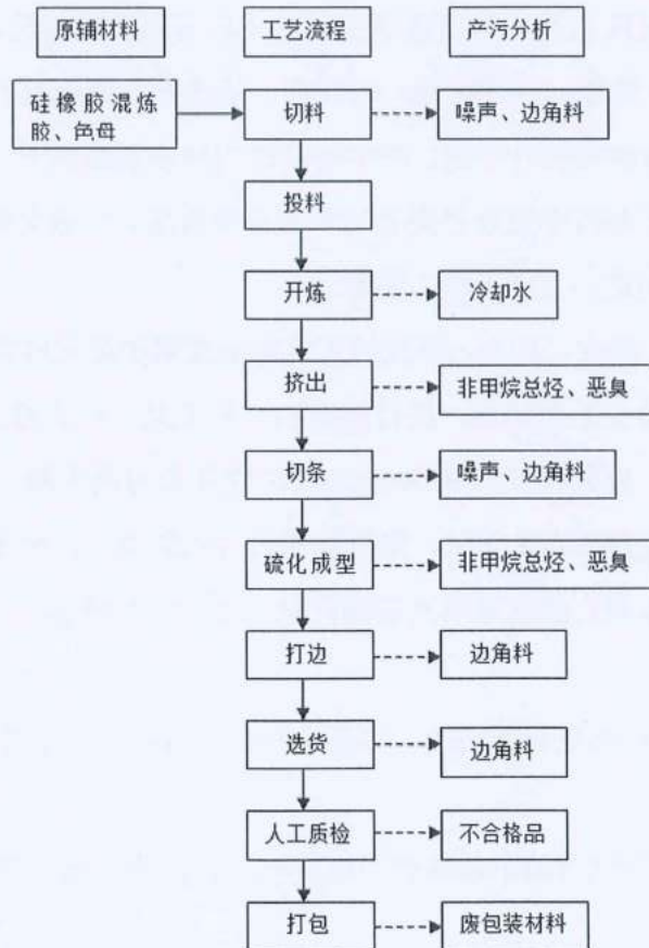
图 3.6 生产工艺流程及产污节点图
